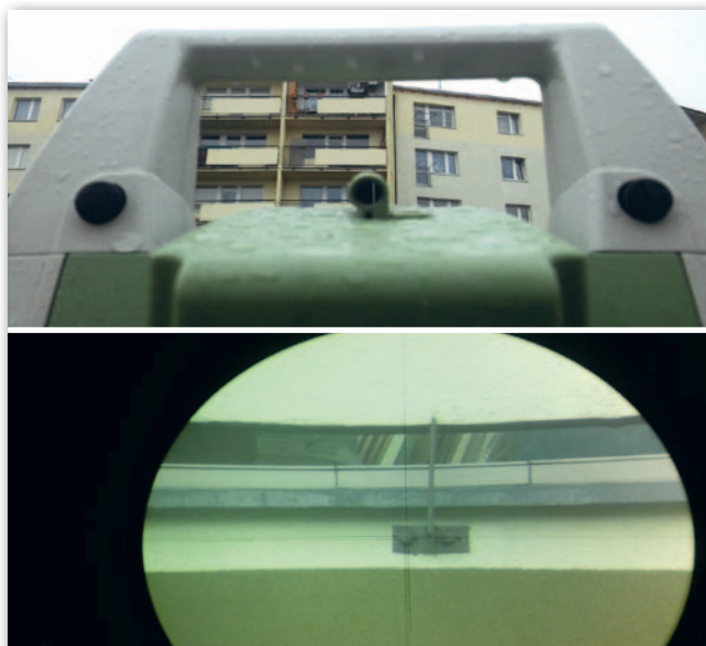
Fot. 1. Szczegół w postaci lewej śruby mocowania barierki balkonu
