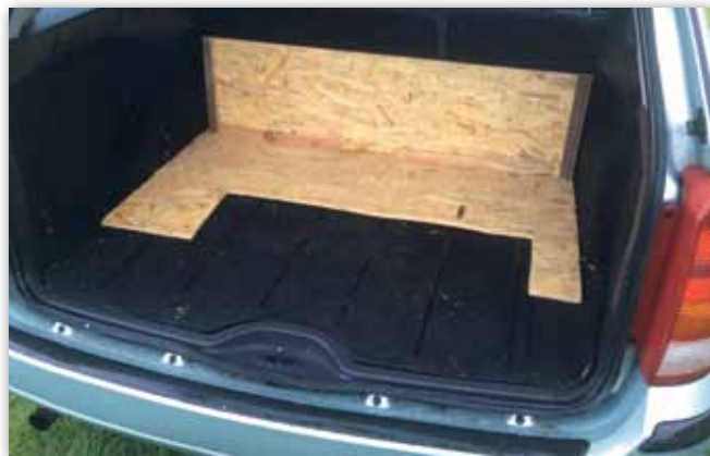
Fot. 6. Wycięcie pod koło zapasowe
