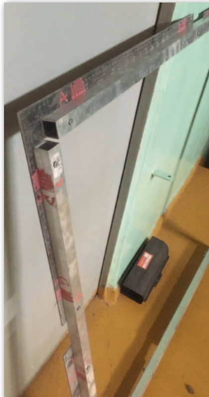
Fot. 1. Rama pomiarowa została skrócona za pomocą śrub; zamiast zwykłych nakrętek wykorzystano „motylki”. Warto zwrócić uwagę na oznaczenia na ramie, które ułatwiają skrócenie ramy w całość. Każdy otwór w rurce aluminiowej ma przyporządkowany otwór w kątowniku
